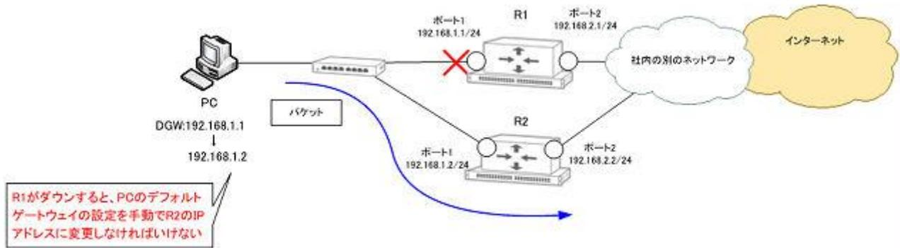
サーバと端末のネットワーク経路を複数用意し、ネットワークでの障害発生時に業務を停止しないよう、経路切換えで対応します。
